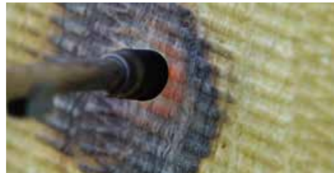
Steinwolle im Brandversuch
